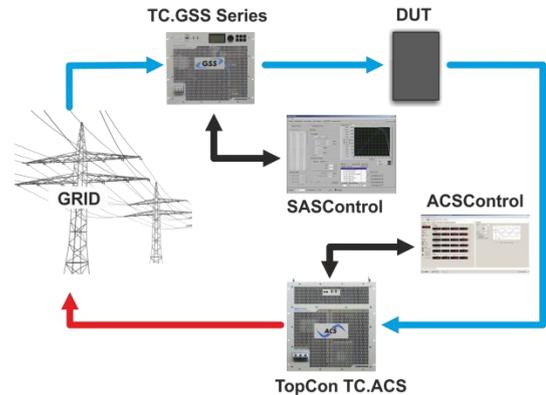
在上述测试环境中增加双向能量反馈型TC.GSS系列直流电源，即可完成储能组件的模拟。
