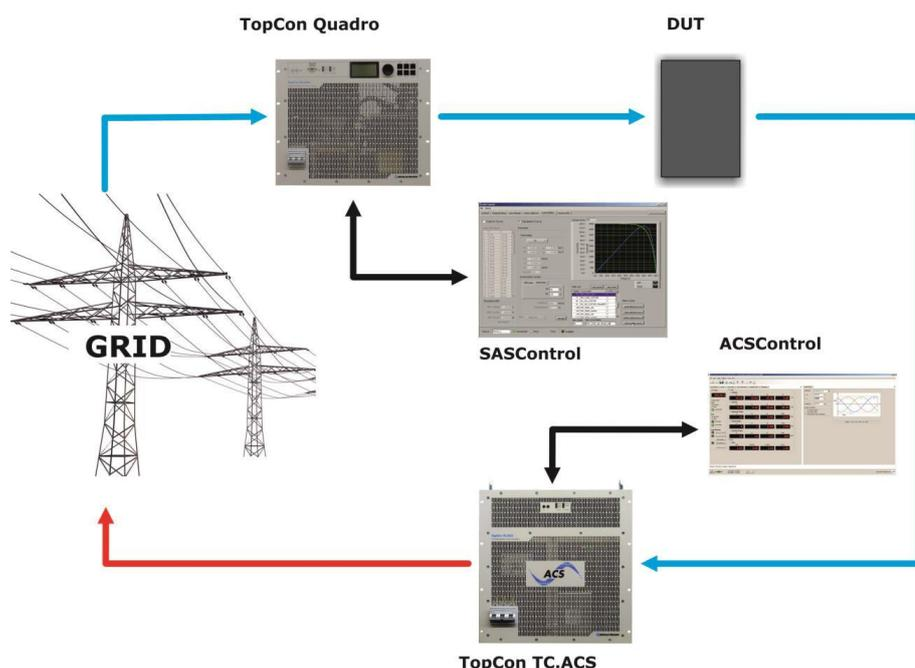
太阳能逆变器集成测试环境，由太阳能电池阵列模拟块（SAS），被测设备（DUT）和电网仿真系统（GRS）组成。而 Regatron TC.P 光伏模拟电源允许用户定义的一个太阳能电池阵列在任意条件下的仿真，TC.ACS 同时定义了不同试验条件对电网的连接。
