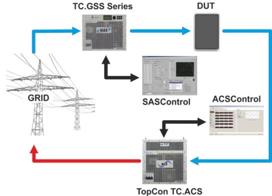
在上述测试环境中增加双向能量反馈型TC.GSS系列直流电源，即可完成储能组件的模拟。
