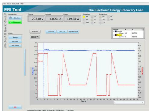
存储于采样存储器的测量数据可以导出并在Data Viewer中显示。测量数据还可以保存为.CSV格式文件以便后期处理。
